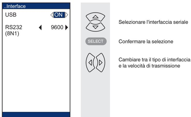
Le interfacce possono essere attivate e disattivate. Per estendere la durata della batteria, le interfacce dovrebbero essere disattivate se non vengono utilizzate.
