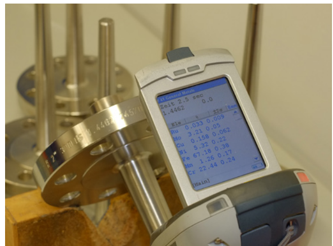
Teste de PMI: análise de fluorescência de raios X da haste do poço termométrico
