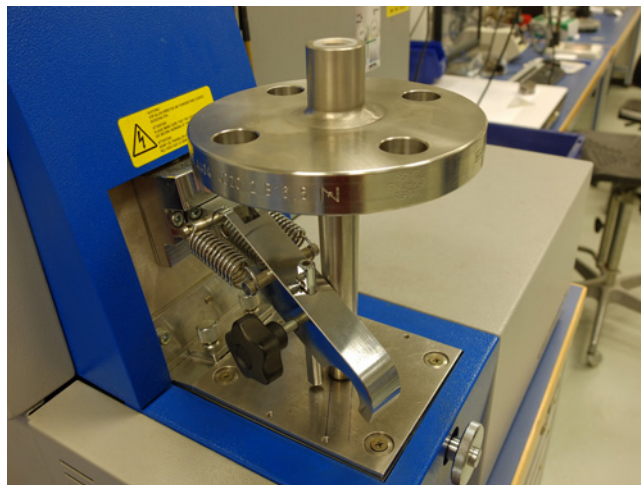
Teste de PMI: análise espectrográfica em um poço termométrico flangeado modelo TW10
