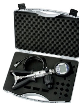
Version de base avec génération pneumatique de pression
