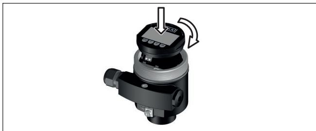
Рис. 32: Установка модуля индикации и настройки в отсеке электроники однокамерного корпуса
