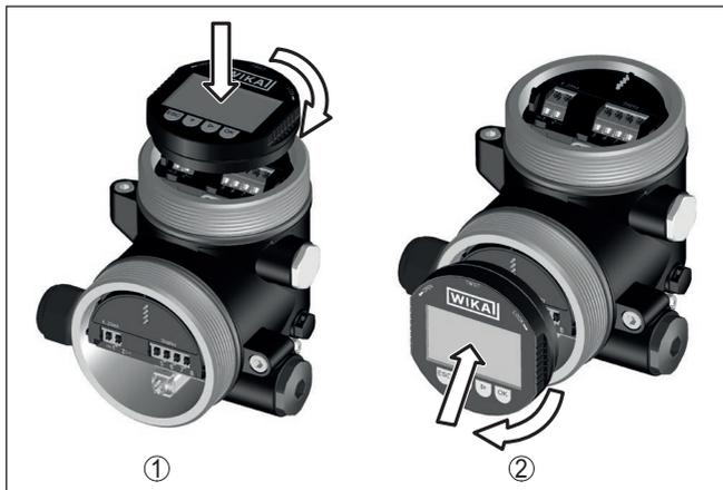
Abb. 39: Einsetzen des Anzeige- und Bedienmoduls beim Zweikammergehäuse
