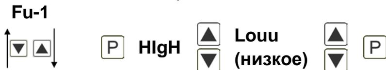
Чтобы выполнить индикацию при снижении значения ниже минимального предельного значения, можно выбрать **Loui** (LOW = минимальное предельное значение), а если значение возрастает и превышает верхнее предельное значение, можно выбрать **HlgH** (HlgH = верхнее предельное значение). LOW соответствует принципу тока покоя, а HlgH - принципу рабочего тока.
