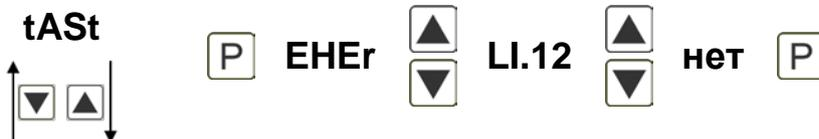
Здесь можно ввести для режима эксплуатации либо запрос МИН/МАКС значения, либо корректировку порогового значения с помощью клавиш курсора. Если память МИН/МАКС активирована с **ENEr**, измеряемые МИН/МАКС значения будут сохранены во время эксплуатации и могут быть вызваны с помощью клавиш курсора [**▲**] [**▼**]. Значения будут утеряны при перезапуске прибора.
