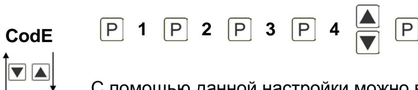
С помощью данной настройки можно выбрать индивидуальный код (рабочая настройка 1 2 3 4) для блокировки клавиатуры. Для блокировки/активирования кнопки действуйте согласно разделу меню **pin**.
