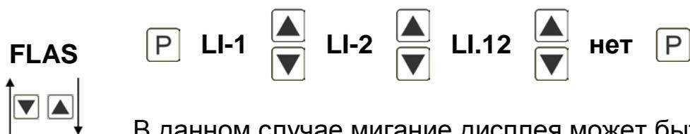
В данном случае мигание дисплея может быть добавлено как дополнительная функция сигнализации либо к первому предельному значению (выбрать: **LI-1**), ко второму предельному значению (выбрать: **LI-2**) или к обоим предельным значениям (выбрать: **LI.12**). С помощью **нет** (рабочая настройка) мигание не активизируется совсем.
