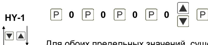
Для обоих предельных значений, существует функция гистерезиса, которая срабатывает согласно функциональному принципу (рабочий ток/ток покоя).
