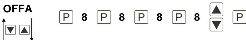
С помощью данной функции Вы можете изменить масштаб значения входа 4-20 мА (заводская настройка) без применения измерительного сигнала. Если выбрана калибровка сенсора, данные параметры не доступны.
