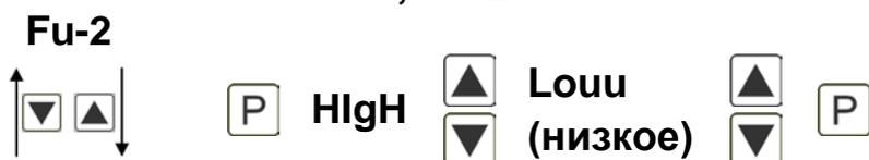
Чтобы выполнить индикацию при снижении ниже минимального предельного значения, можно выбрать Low (LOW = минимальное предельное значение), а если значение возрастает и превышает верхнее предельное значение, можно выбрать high (HIGH = верхнее предельное значение). LOW соответствует принципу тока покоя, а HIGH - принципу рабочего тока.
