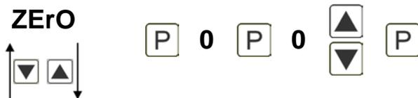
С помощью стабилизации в нулевой точке можно предварительно выбрать диапазон значений вокруг нуля, при котором дисплей показывает ноль. Если, например, установлено 10, дисплей будет показывать ноль в диапазоне от -10 до +10 и продолжит отображение ниже этого диапазона, начиная с -11, и выше него, начиная с +11.
