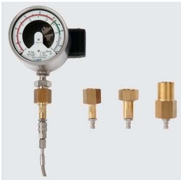
Выберите подходящий переходник и накрутите на тестируемый прибор. Подсоедините тестируемый прибор с помощью быстроразъемного соединителя с металлическим гибким шлангом.
