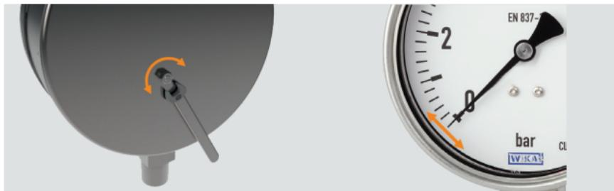
Если стрелка отклоняется от нулевой точки (без подачи давления), регулировку точки нуля можно выполнить путем поворота шестигранной гайки, расположенной сзади прибора. Для регулировки шестигранной гайки нужен гаечный ключ 7 мм. Диапазон регулировки составляет  $\pm 25^\circ$ .
