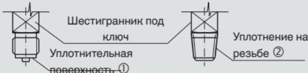
Момент затяжки зависит от используемого уплотнения. Для облегчения ориентации рекомендуется выполнять присоединение манометра с помощью LH-RH соединения или накидной гайки. Если манометр оснащен устройством сброса давления, его необходимо защитить от блокировки твердыми отложениями и грязью.
