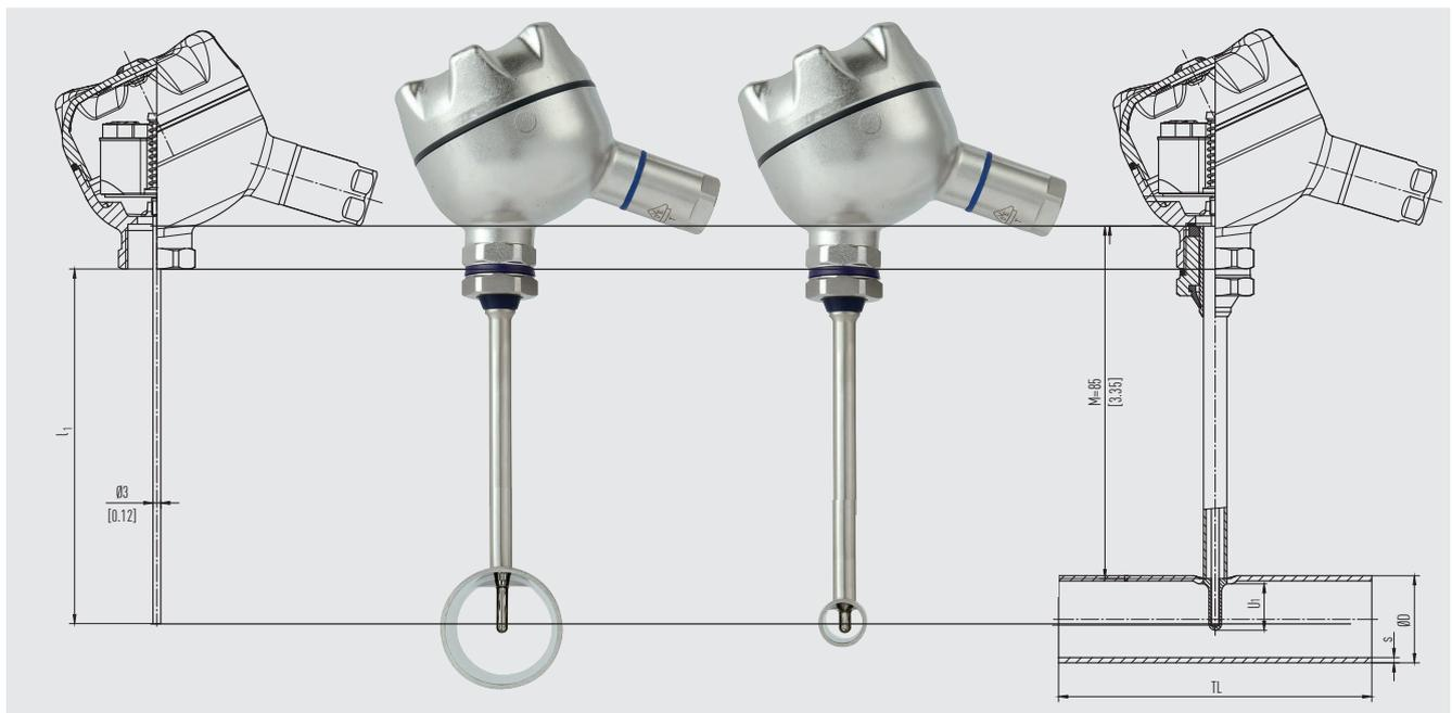
La longitud del tubo de cuello M variable permite utilizar unidades extraíbles con longitudes de montaje estandarizadas  $l_1$ . Esto reduce el número de opciones y, por tanto, las necesidades de almacenamiento de distintas piezas de recambio. Además, asegura la utilización de la longitud de montaje correcta en caso de sustitución.
