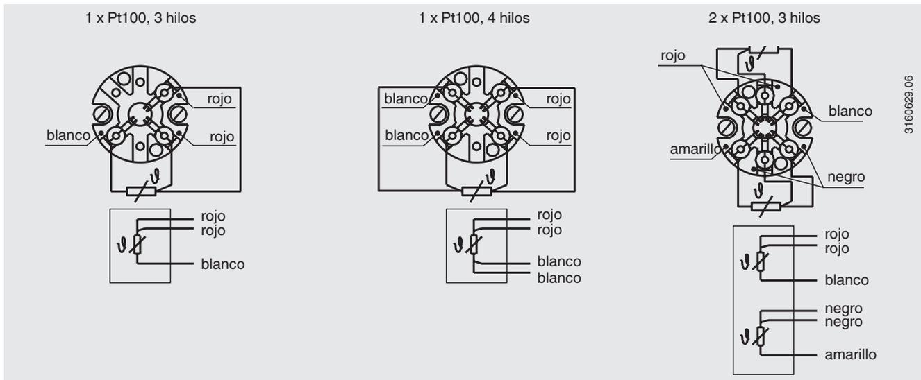
Consultar las conexiones eléctricas de los transmisores de temperatura incorporados en las correspondientes hojas técnicas o en los manuales de instrucciones.
