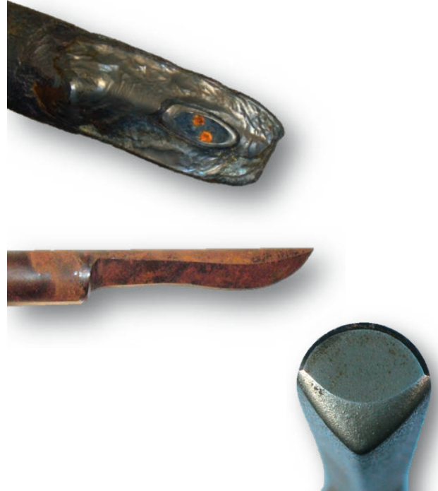
Dommages sur les doigts de gant subissant une contrainte abrasive (exemples)
