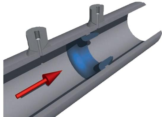
Durchflussdüse zum Rohrleitungseinbau,
