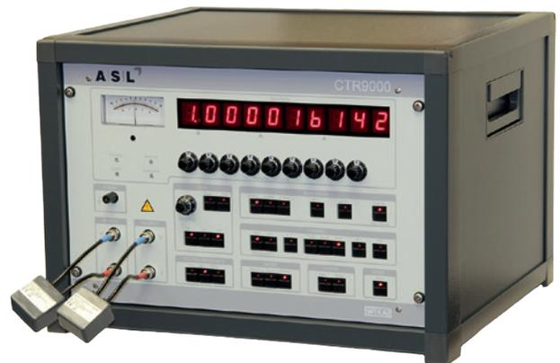
**Ponte resistivo campione primario modello CTR9000,
