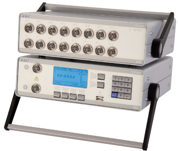
Termometro di precisione, modello CTR5000 con multiplexer CTS5000
